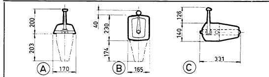
Till backslaget kan även levereras en reduktionsväxel med utväxlingsförhållandet 2:1. Den är svängbar så att utgående axeln kan ligga antingen under eller över motorns centrumlinje.
